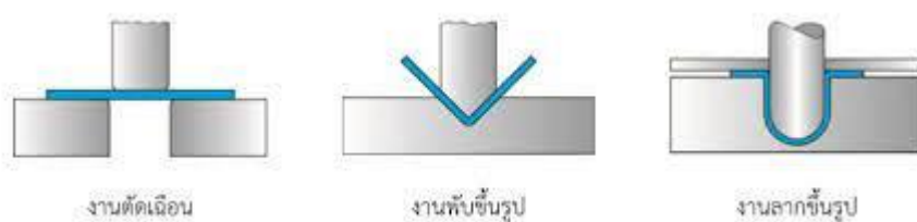
ภาพที่ 2-1 กระบวนการขึ้นรูปโลหะแผ่น
