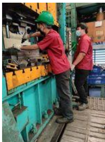
ภาพที่ 3-10 การทดลองปั๊มแม่พิมพ์
