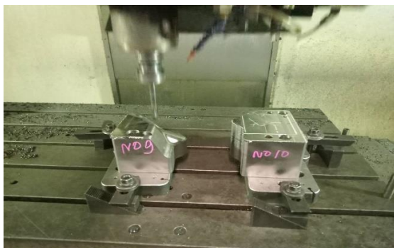
ภาพที่ 3-6 CNC MILLING ก้อน IN sert
