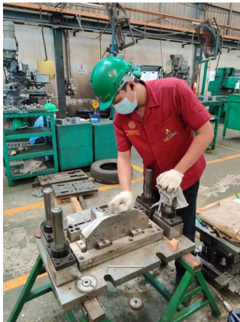
ภาพที่ 3-8 ขัดเงาก่อน IN sert
