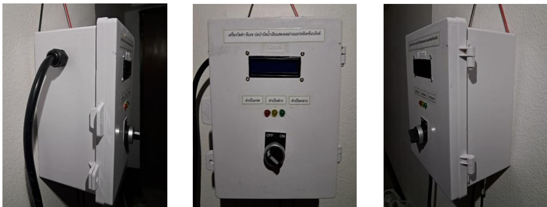
ภาพที่ 1 เครื่องวัดค่า พีเอช บ่อบำบัดน้ำเสียแสดงผลผ่านแอปพลิเคชันบลิงค์
