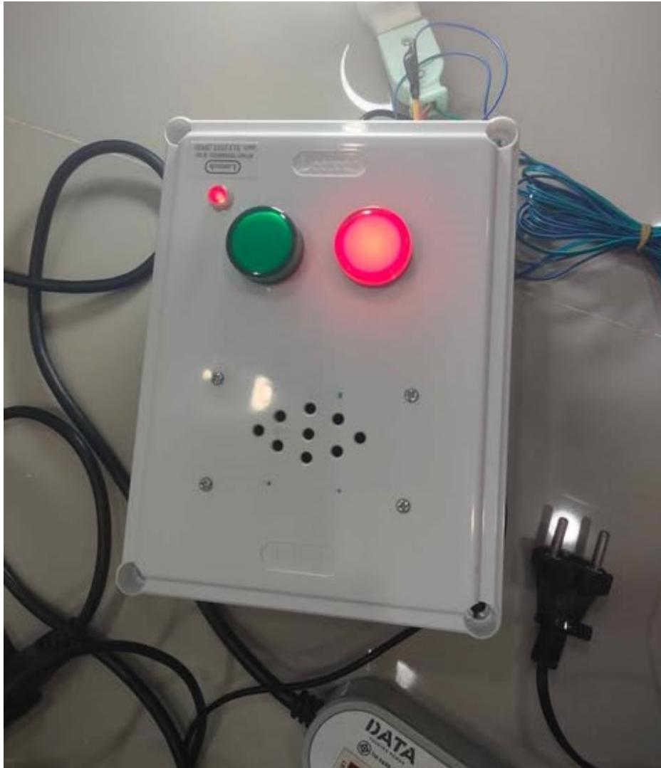
ภาพที่ 8 ทดสอบการแจ้งเตือนไฟรั่วแจ้งเตือนด้วยเสียง และแสง
