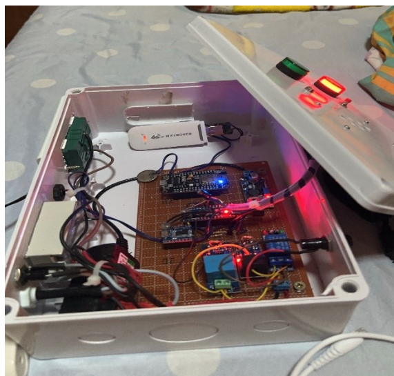
ภาพที่ 4 ประกอบอุปกรณ์และบอร์ดต่างๆลงในกล่อง
