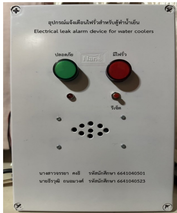
ภาพที่ 7 อุปกรณ์แจ้งเตือนไฟรั่วสำหรับตู้ทำน้ำเย็นด้วยระบบแอปพลิเคชันไลน์
