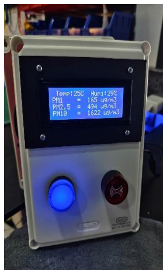
รูปภาพที่7. ทดลองการเชื่อมต่อข้อมูลวัดค่าฝุ่นอนุภาคนิวความชื้นและเก็บข้อมูลผ่าน google sheet
